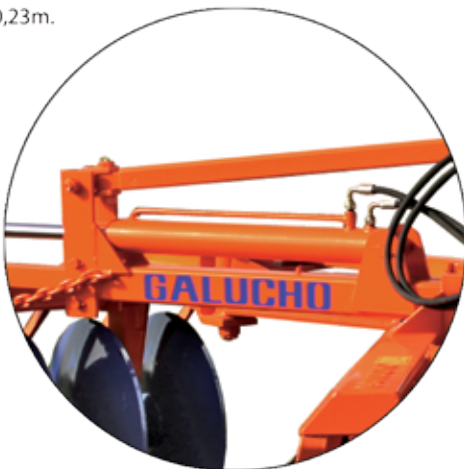
Conjunto hidráulico para abertura e fecho dos corpos, opcional. Système hydraulique pour ouverture et fermeture des trains, option. Hydraulic cylinder for gang angling, option.
