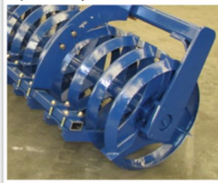
Cubos dos discos com sistema de lubrificação e protecção.
