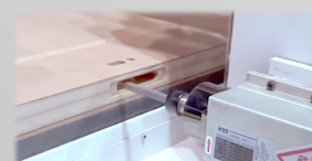
Mecanizado de puertas con motor horizontal
