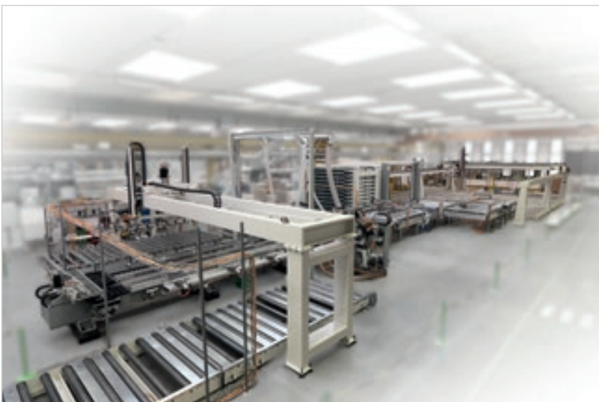
Instalaciones Batch-One con almacenes interoperacionales (Buffer y Sorter) completamente integrados.
