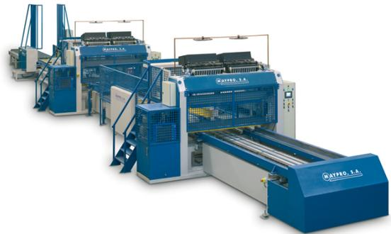
LC2 Línea de clavado automática de palets con dos clavadoras
