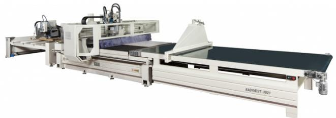
Línea de Nesting con cargador automático, etiquetadora automática con carga y descarga.
