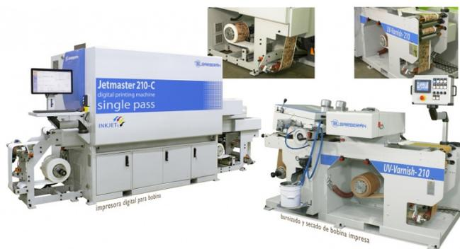
Sistema de impresión digital sobre bobina, módulo para barnizar y secar bobinas impresas.
