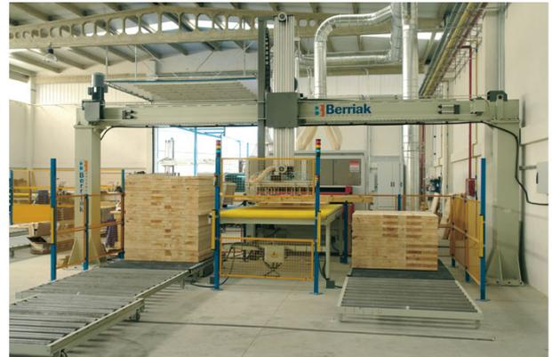
Alimentador-Apilador Puente Columna
