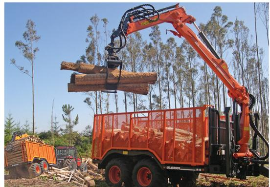
Remolques de tracción hidráulica
