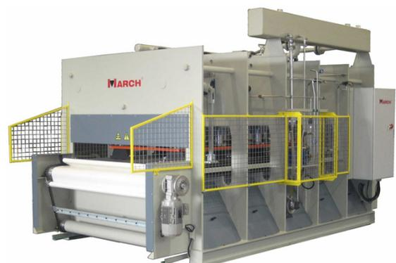
PRENSA CICLO CONTINUO PCC Prensa de ciclo continuo destinada a realizar el recubrimiento de tableros y paneles con chapas de madera, HPL y otros materiales en sus dos caras. Esta máquina dispone de una pantalla táctil para su control y puesta en marcha mediante la cual podemos ajustar tiempos,
