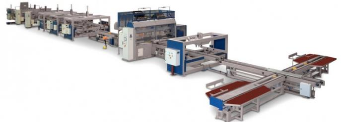
LÍNEA AUTOMÁTICA DE CLAVADO Y MECANIZADO DE ALAS PARA BOBINAS DE MADERA DESDE 600 mm HASTA 3000 mm.
