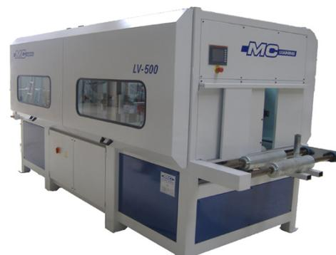
LV 500 Lijado de vigas i tablas a tres caras en una sola vez posibilidad de colocar herramientas para envejecer. Destinada para carpintería exterior cubiertas y abuardillados.
