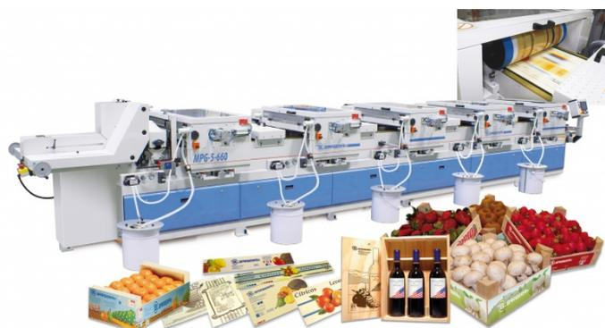
Maquina Impresora de tabillitas con sistema automático de alimentación de tabillitas, con cabezales de aplicación sistema offset.
