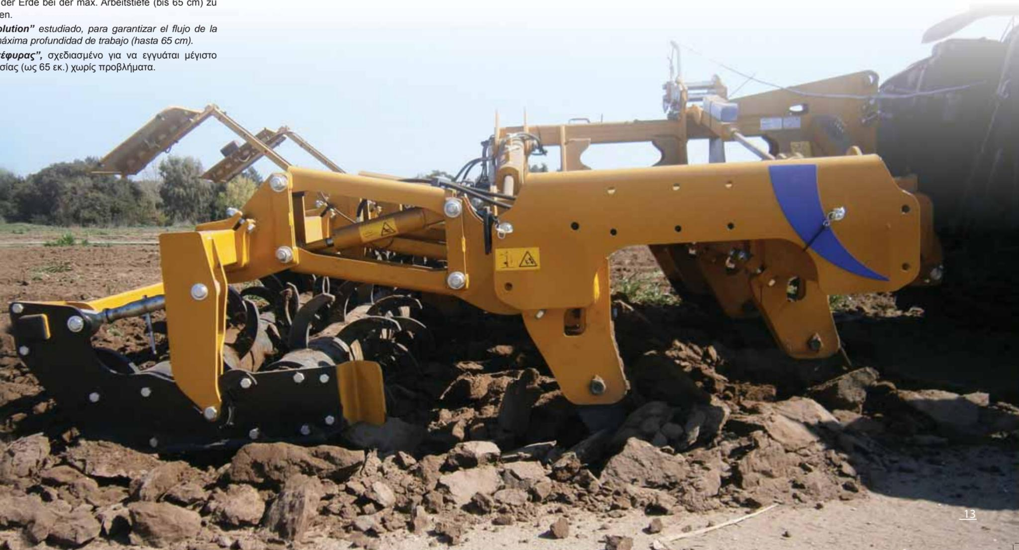
**Klappbare Tiefenlockerer für Traktoren bis max 500PS**
