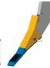
**Verschleißfeste Pflugschar**, sonder-Sicherheit gegen Verschleiß an der Spitze der Zinke angebracht.
