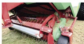
Die Beschleunigerwalze hat 200 mm Durchmesser und dreht in die gleiche Richtung wie die Pickup, um das Material quasi in den (100 mm nach oben versetzten) Rotor zu werfen. Genauso wie das Runden auf der Walze sind die Zinken der umgestellten Pickup spiralförmig nach außen angeordnet, um das Material möglichst zu den Seiten zu ziehen.
