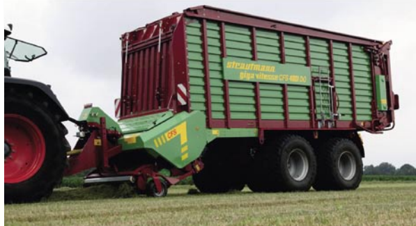
Die 45 Messer des Schneidwerks sind jetzt größer und haben zwei Aufnahmeleichen. Außerdem wurden die Federn der Fremdkörper-sicherungen gedreht, damit sie sauberer bleiben.
