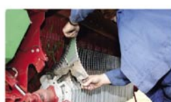
Die 45 Messer des Schneidwerks sind jetzt größer und haben zwei Aufnahmeleichen. Außerdem wurden die Federn der Fremdkörper-sicherungen gedreht, damit sie sauberer bleiben.
