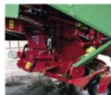
Die Walze wird auf der rechten Seite über ein Winkelgetriebe und eine Gelenkwelle mit Rutschkupplung angetrieben. Auf der linken Seite geht ein Kettenantrieb mit Freilauf von der Walze zum Pickup.
