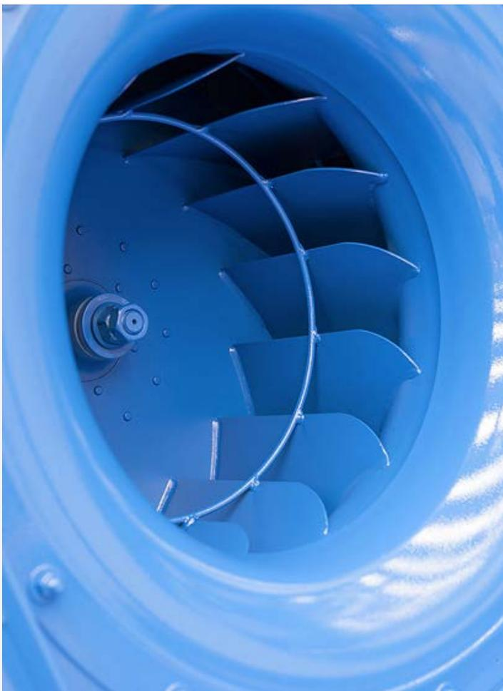
gracias a unos desviadores internos montados en el difusor, inyecta dentro del secador un único flujo de aire a temperatura constante y homogéneo circularmente garantizando el calentamiento uniforme del producto y evitando, consiguientemente, que el secado sea irregular.
