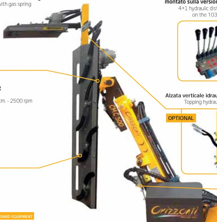
**Distributore idraulico 4+1 montato sulla versione 103410L**
