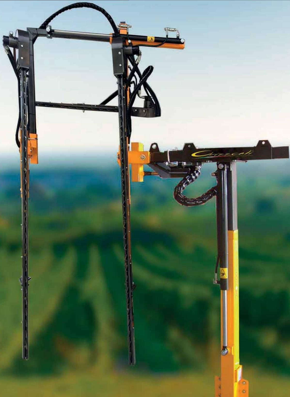
cod. 103231L - versione allestita con distributore idraulico - version equipped with hydraulic distributor
