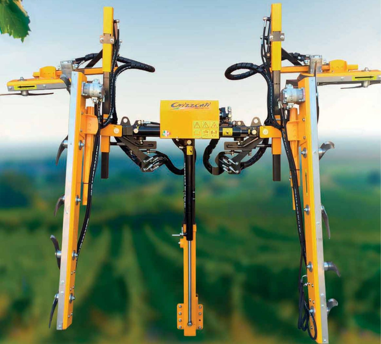
cod. 103242J - versione con distributore elettroidraulico 5+1 - version equipped with 5+1 electro-hydraulic distributor
