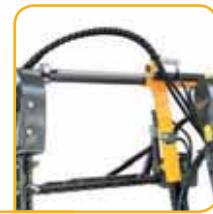
**Distributore idraulico 4+1 montato sulla versione 103343L**
