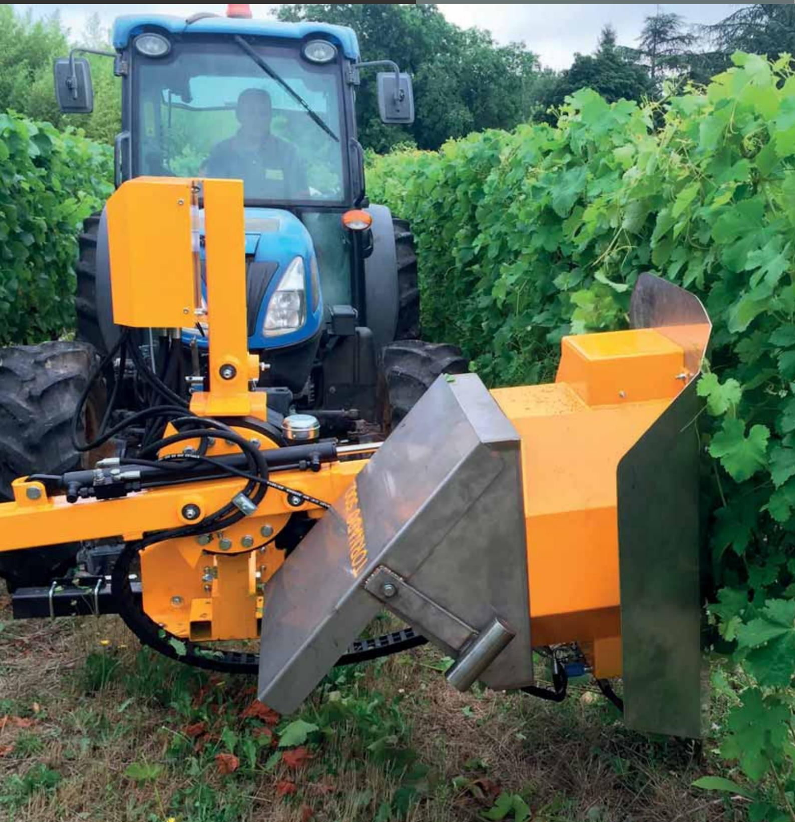
cod. 103200L - versione allestita con distributore idraulico - version equipped with hydraulic distributor
