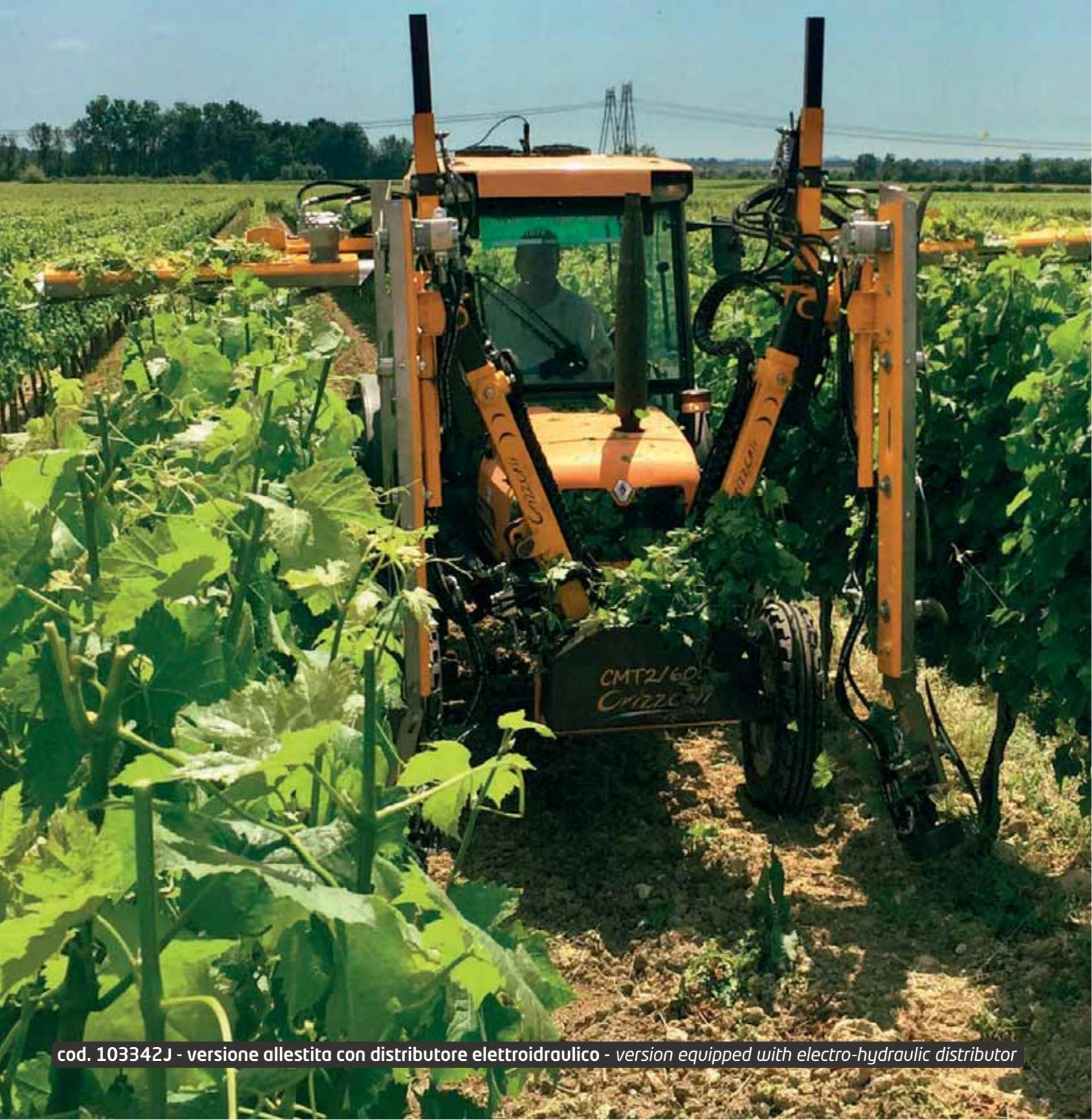
cod. 103342J - versione allestita con distributore elettroidraulico - version equipped with electro-hydraulic distributor
