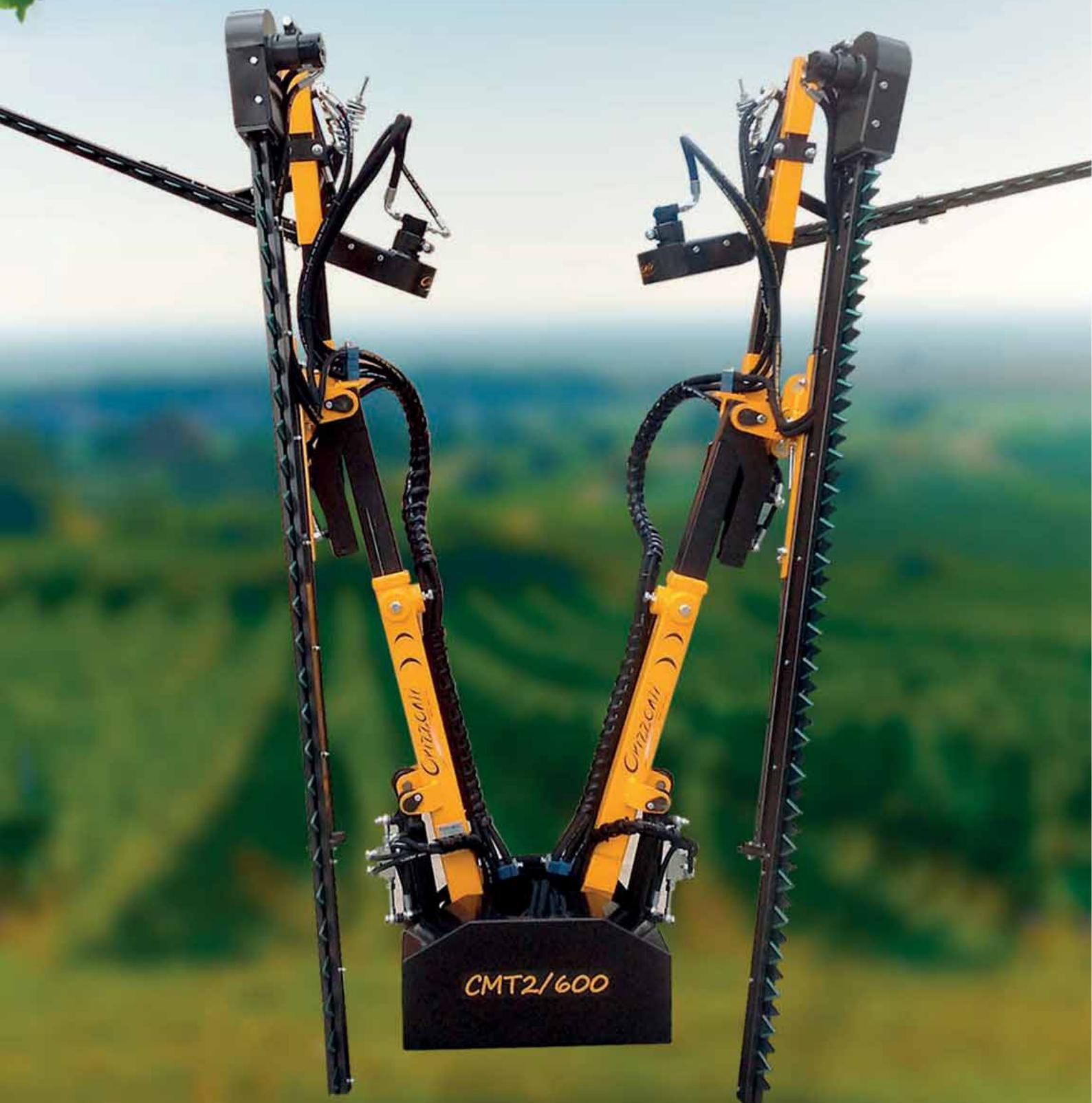
cod. 103321J - versione allestita con distributore elettroidraulico - version equipped with electro-hydraulic distributor
