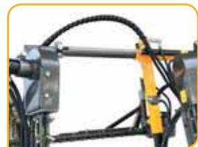
**Distributore idraulico 4+1 montato sulla versione 103243L**
