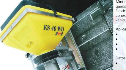
Mini esparcidor KS 40 WD, se puede instalar tanto en quads, portones traseros de camiones o pick-ups. Fabricado en acero inoxidable, solo precisa de una conexión a 12V . Dispone de un mando acoplado al vehículo para el control automático del esparcido.
