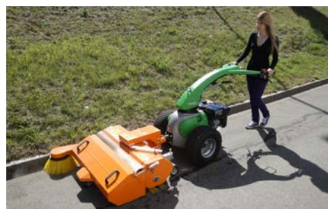
Rapid Mondo con spazzatrice combinata, contenitore raccogli sporco e spazzola laterale
