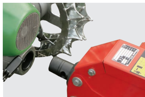
Sistema di cambio veloce senza attrezzi
