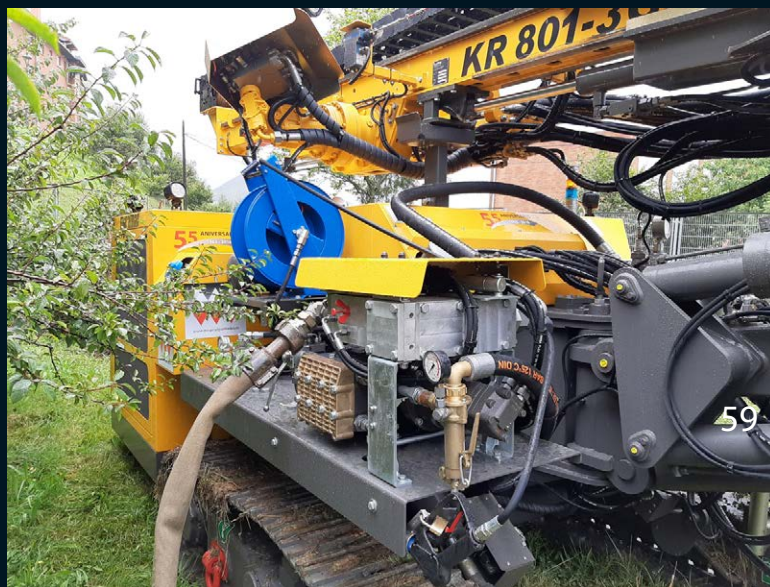
Los equipos Klemm equipan desde hace muchos años bombas de caudal variable y el sistema de eficiencia energética Power Sharing.
