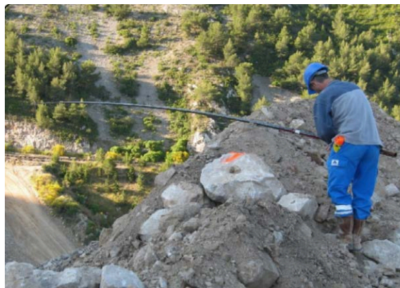
Figura 1: Uso de una caña de pescar para estimar la altura del frente y la piedra en el pie de banco.
