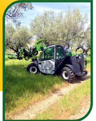
**Pinza a doppia ganascia New Generation ad alte frequenze, autocentrante, autofrenante**
