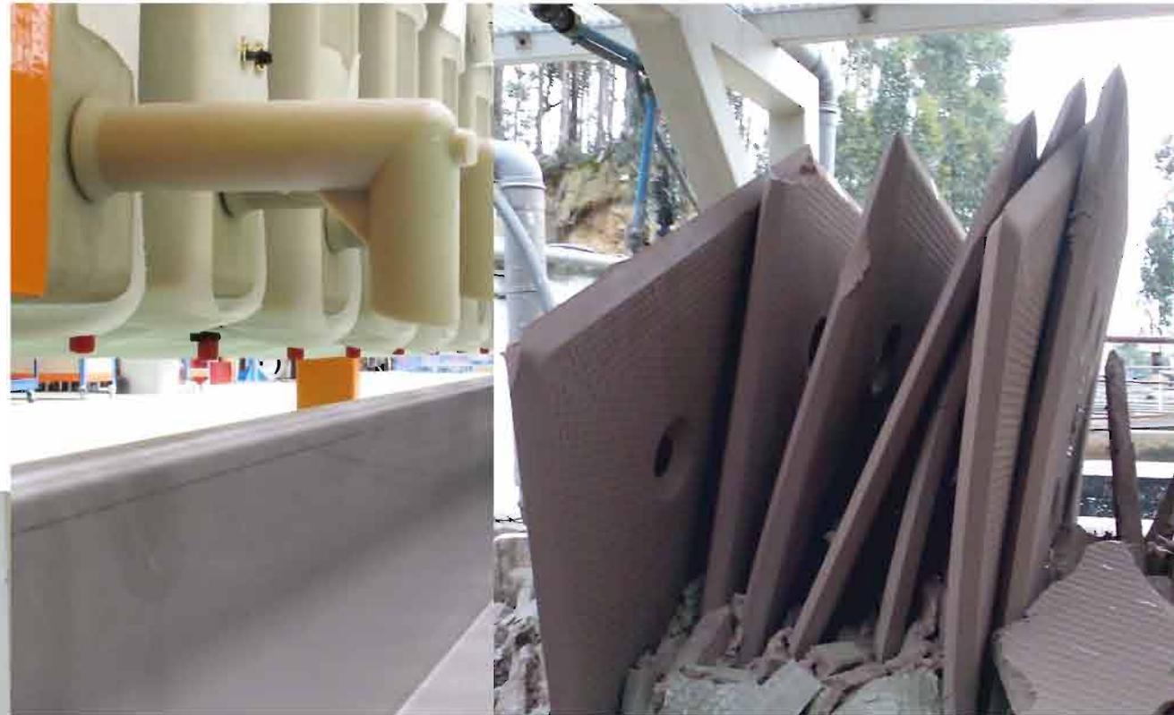
Residuo generado por la deshidratación del fango en una EDAR con filtro prensa.
