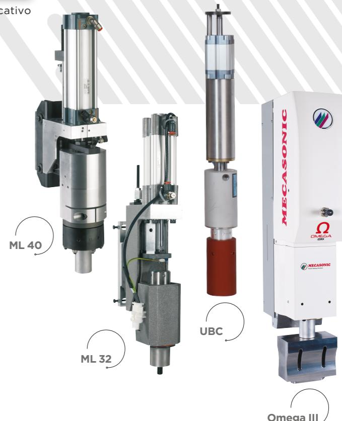
Los módulos de ultrasonidos son unos conjuntos compactos para una integración fácil en sus cadenas de producción. Están destinados a concepciones de máquinas especiales y a los integradores.
