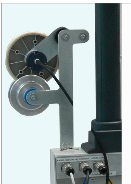
Dispositivo de medición mediante encoder
