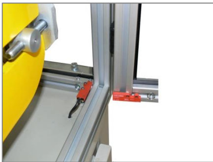
Sistema de seguridad de apertura del protector de las orugas
