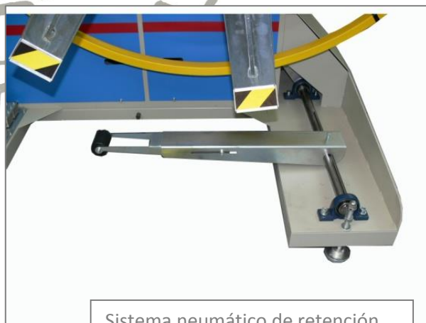
Sistema neumático de retención para evitar el desenrollado
