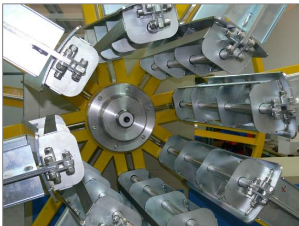
Núcleo formado por 6 o 8 palas regulables en diámetro
