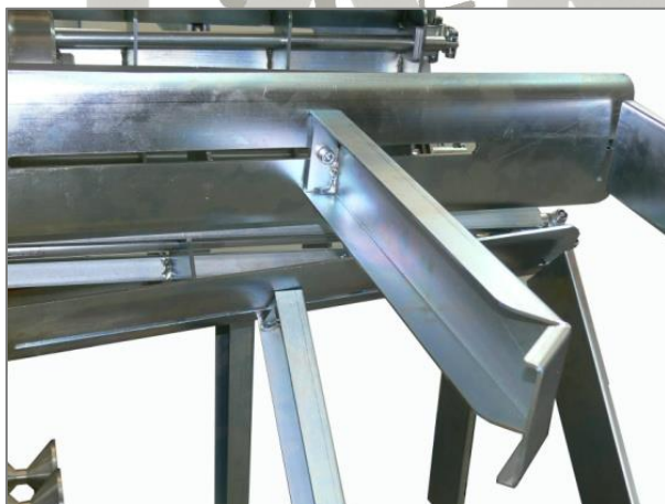
Limitadores para regular el ancho del rollo
