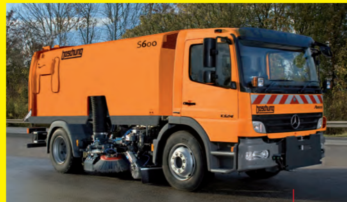
S600 Barredora montada sobre camión 6,0 m 3
