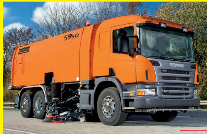
S600 Barredora montada sobre camión 6,0 m³
