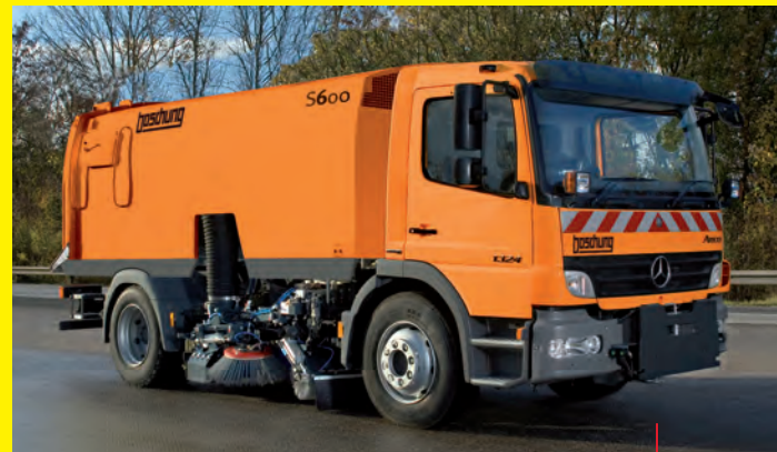
S600 Barredora montada sobre camión 6,0 m³
