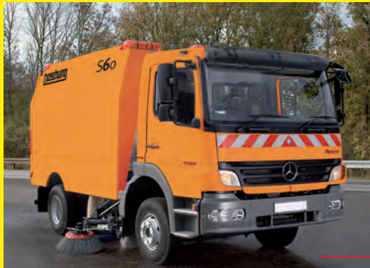
S60 – Barredora adaptable de 6,0 m³ de capacidad.
