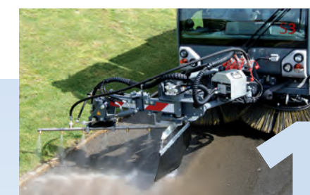
Montaje de barra de baldeo frontal
