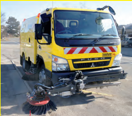
S40 – Barredora compacta de 4,0 m³ de capacidad.
