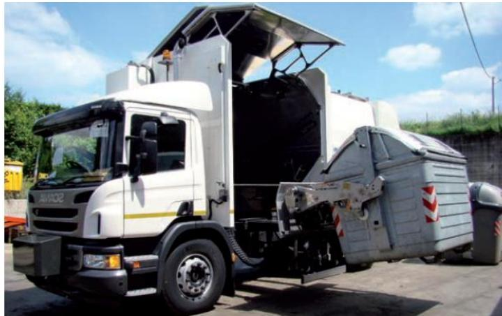
El sistema elevador en el lado izquierdo, o en el lado derecho del vehículo, realiza el acoplamiento, manipulación, lavado y reposicionamiento de los contenedores de 660 a 1100 litros norma DIN y de 2200, 2400 y 3200 litros de carga lateral.
