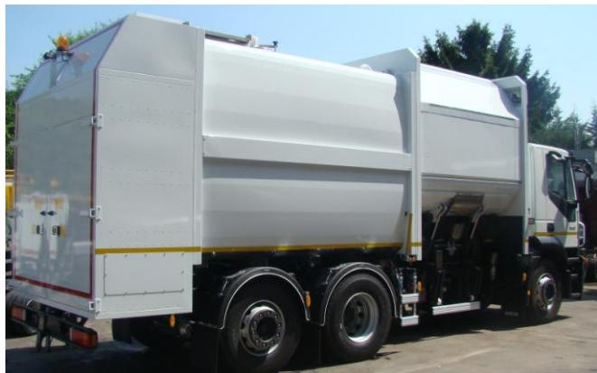
El diseño y el desarrollo preciso, nos ha permitido fabricar una máquina con unas dimensiones muy compactas. Nuestro sistema de eleva-contenedor en posición de descanso posiciona los brazos en la parte exterior, para iniciar el enganche. De esta forma, no se pierde tiempo en el lavado abriendo el portón de la cámara de lavado y a continuación tener que desplegar el eleva-contenedor.
