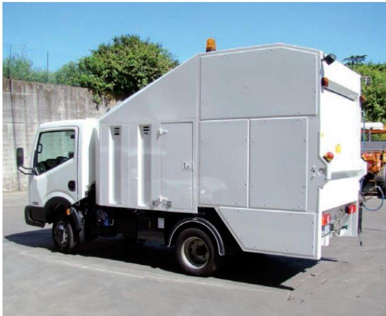
El Lava-Contenedor MINI-35 ha sido diseñado con objetivos prácticos y sencillos: Carnet de segunda B, ahorro de peso y coste, solo disponible con la configuración de distancia entre ejes de 2.500 mm y anchura máxima del equipo de 1.800 mm.
