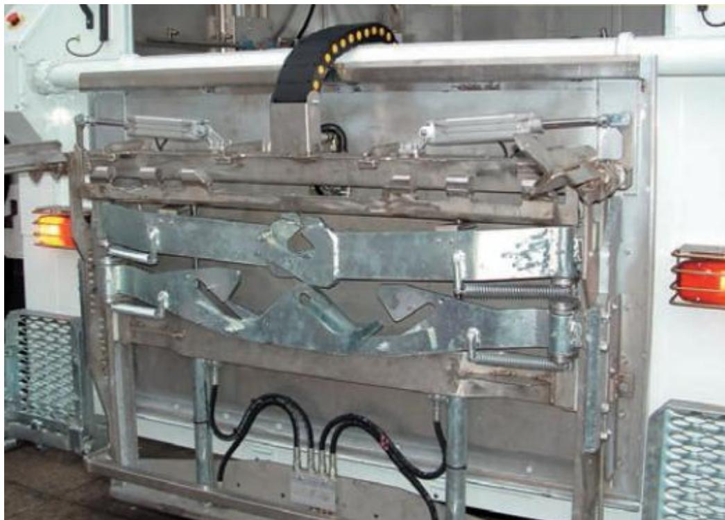
El robusto elevador es de alta calidad y de alta resistencia. Hoy en día se fabrica íntegramente en acero inoxidable, para garantizar una larga eficiencia y durabilidad del equipo. Una gran variedad de contenedores se pueden cargar: 60 hasta 1100 litros de tapa plana y tapa curvada norma DIN.
