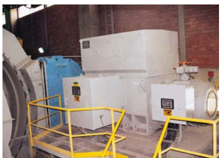
3600kW, 6 polos, 6600V, carcasa MAW630 Aplicación: Molino
