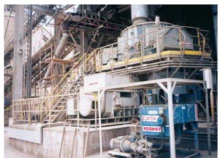
2 x 1100kW, 6 polos, 6600V, carcasa MAF500 Aplicación: Molino vertical
