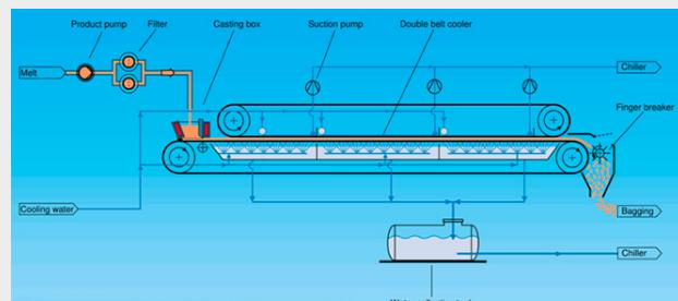
Cuando se desea disponer de una gran capacidad de enfriamiento con unas dimensiones limitadas, se recurre a un enfriador de doble cinta. El producto se alimenta sobre la cinta inferior, y la capa avanza entre las
