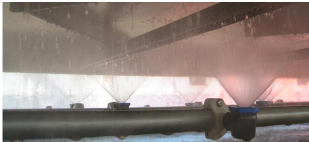
El proceso es tan simple como ingenioso. El calor desprendido durante la solidificación y el enfriamiento es transferido uniformemente al agua refrigerante, a través de la cinta de acero.
