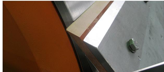
Al final del enfriador, se descargan las pastillas con la ayuda de un rascador de cuchilla a través de una tolva, sobre el sistema de transporte o de almacenamiento.
