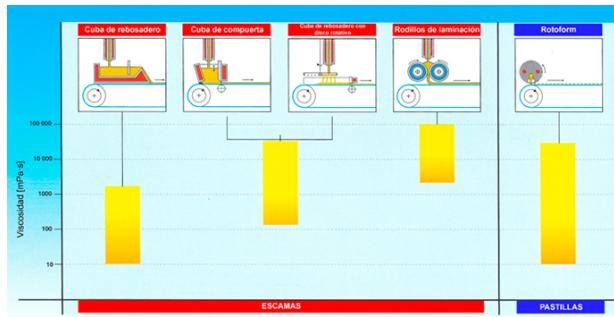
El producto es bombeado desde un reactor o depósito mediante tuberías calefaccionadas, hasta el sistema de alimentación. Este se encarga de dosificarlo adecuadamente sobre la cinta de acero. La tecnología utilizada para alimentar el producto depende por un lado de la presentación deseada, y por el otro de la viscosidad del producto a la temperatura de alimentación.
