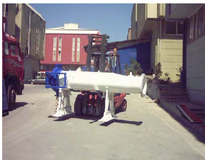
Trampa de rascadores en planta de distribución
