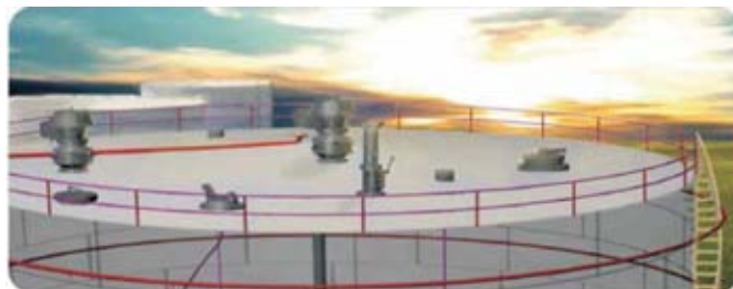
Parte superior de tanque con equipamiento
