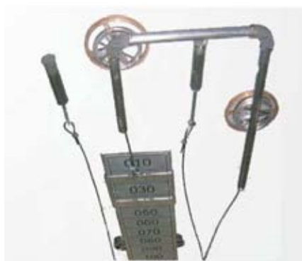
Indicador de nivel tanques
