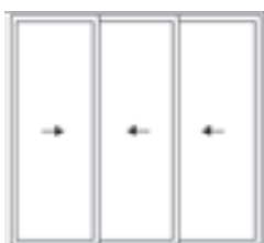
Apertura derecha (Vista exterior)
