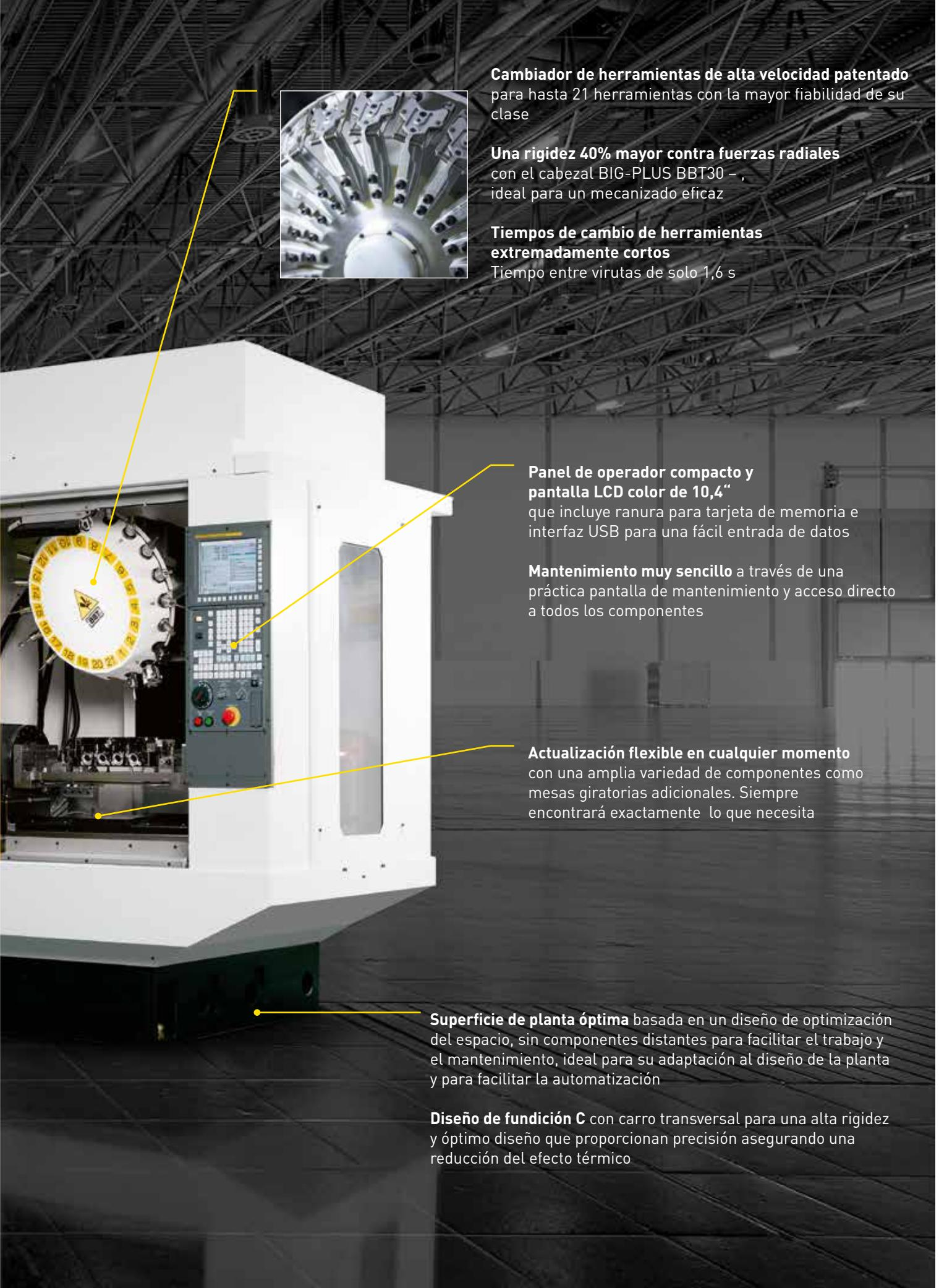
**Cambiador de herramientas de alta velocidad patentado** para hasta 21 herramientas con la mayor fiabilidad de su clase
