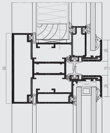
El CW 86 permite crear fachadas apaneladas mediante un sistema de montaje tradicional (CW 86). También permite crear fachadas modulares (CW 86-EF) en la que los paneles se prefabrican completamente en el taller resultando en una rapidísima instalación en obra.
