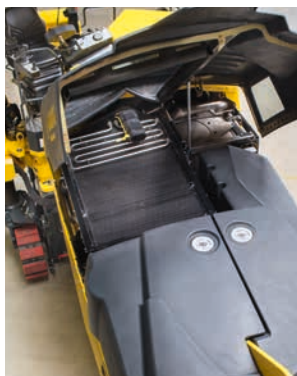
Los sistemas externos de refrigeración tienen una disposición segura que facilita el acceso y el mantenimiento.
