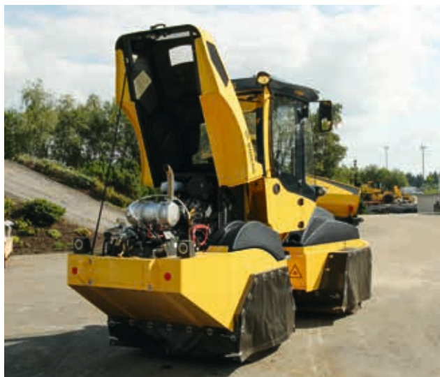
El capó del motor, de amplia apertura, permite un acceso rápido y sin obstáculos al motor.
