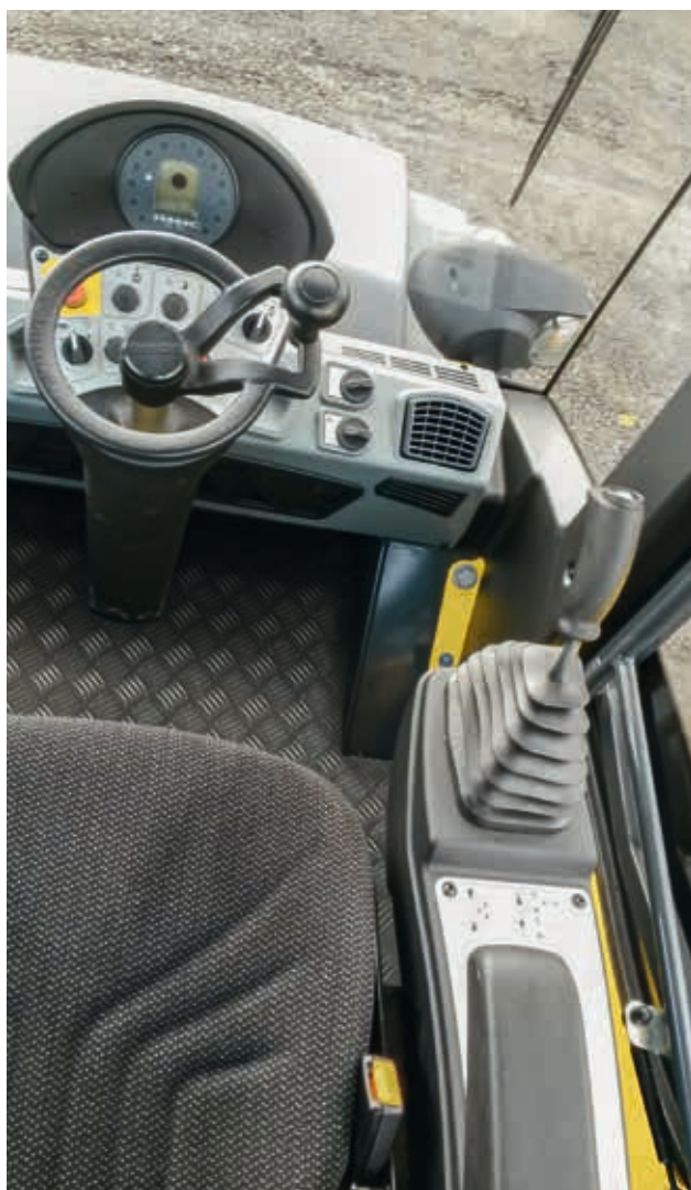
Los principales elementos de mando están cómodamente al alcance y se distinguen con facilidad. Precisión en cada movimiento.
