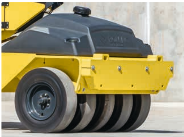
Para aumentar la estabilidad al vuelco, se han instalado muy bajas las cámaras de lastre, aquí la del eje delantero.
