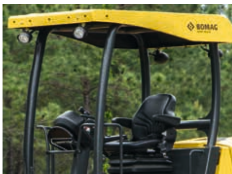
Cuando no se necesita una calefacción o climatizador – el BW 11 RH-5 se suministra también con ROPS/FOPS.
