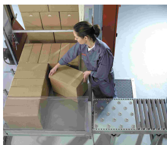
En la bandeja de transferencia, el operador forma el mosaico deseado.
