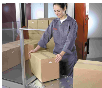
La mesa de rodillos facilita el trasvase a la bandeja de transferencia (accesorio).
