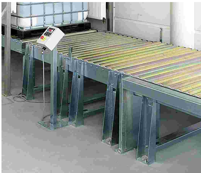
Sistema transportador motorizado de palets de Coloplast en Dinamarca.
