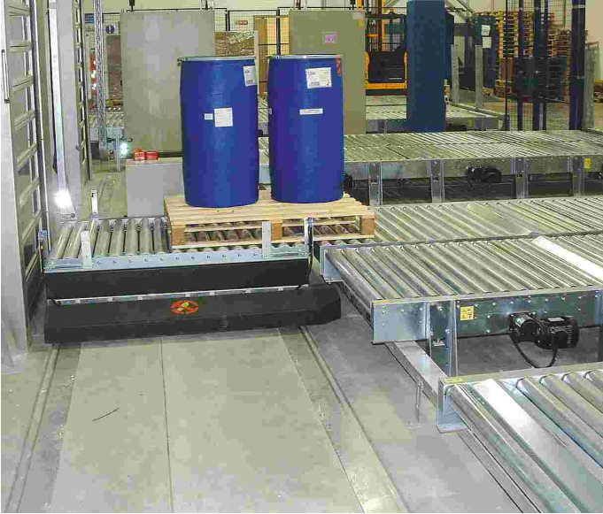
Carro de transferencia integrado en un sistema de transporte de rodillos de palets suministrado a Organon, Irlanda.
