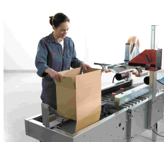
La caja se desplaza hacia abajo y se empuja hacia atrás, y las solapas laterales inferiores se pliegan.
