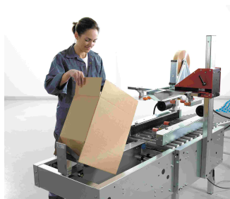
Las solapas delanteras y traseras se pliegan ayudándose con el raíl central.
