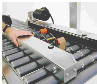
Bandas de arrastre eficientes y fáciles de ajustar al tamaño de caja.
