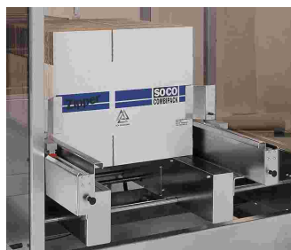
Almacén motorizado de cajas de cartón - fácil de alimentar, incluso con la máquina en funcionamiento.
