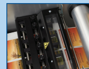
Estación de corte con 7 navajas
