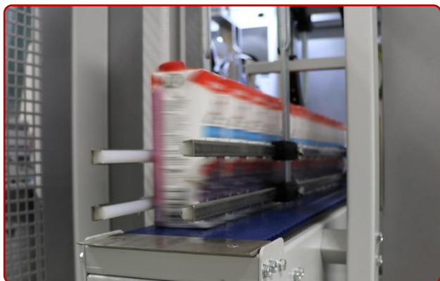
Entrada producto en filas de entrada: 1 única fila u opcional 2-3 filas.
