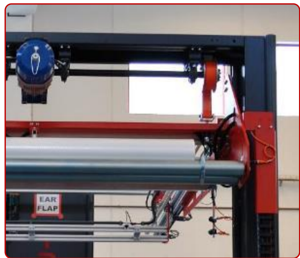
Elevación por eslingas, menos ruido, para un mínimo mantenimiento, ni engrases.
