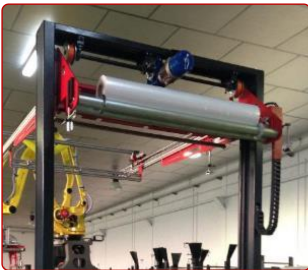
Motor freno para la elevación y descenso de los brazos dispensadores de plástico cobertor
