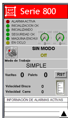
Pantalla principal. Estado y control básico
