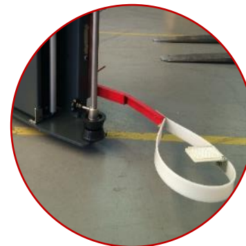
Detector de impacto mediante fotocélula.
