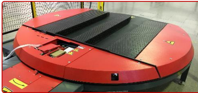
Plataforma con sistema 3ALL incorporado y alzas para envolver carga y palet
