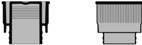
3082 Diámetro interno: 14,55 mm Diámetro externo: 20,45 mm Longitud total: 18,50 mm
