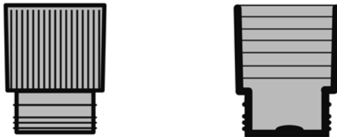
3070 Diámetro interno: 14,90 mm Diámetro externo: 19,20 mm Longitud total: 25,35 mm
