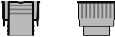
3081 Diámetro interno: 13,80 mm Diámetro externo: 19,88 mm Longitud total: 19 mm
