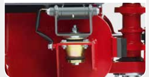
Área de trabajo amortiguada ante vibraciones
