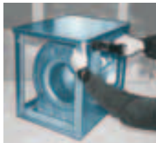
Colocar el techo 5 de forma que tanto el frente 2 como los omegas 4 queden en el interior.
