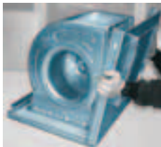
Exteriormente colocar el frente 2, introduciendo la boca del ventilador A en la embocadura y fijar.
