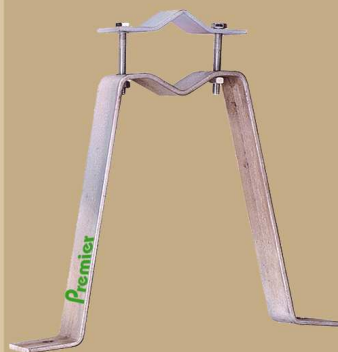
Ref. 1020 Garra doble para tacos y empotrar Pletina de 700x40x5mm Pletina de 130x40x5mm Tornillos M-8x60 M-8 con tuercas
