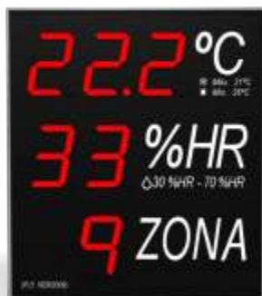
Cuando queremos conocer la temperatura de varias zonas dentro de un mismo recinto utilizamos este display, nos permite conectar hasta 99 sondas de temperatura y humedad en un mismo visualizador, cada 5 segundos muestra el valor de una sonda distinta, indicado de que sonda se trata.
