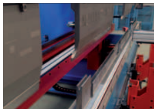
Detalle de la fijación de la matriz sobre la mesa de bombeado WILA. ➡➡
