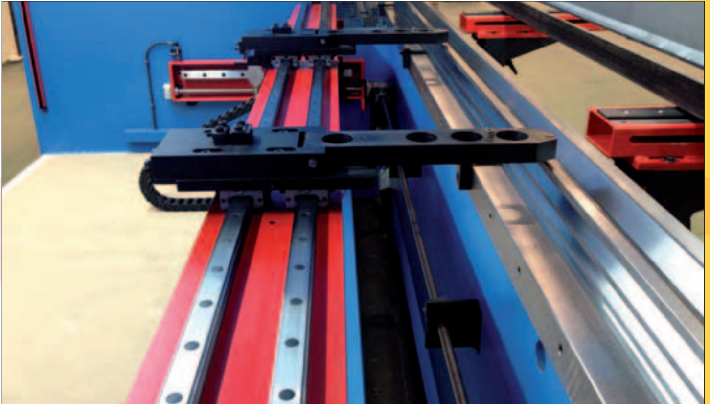
⤴ Tope para máquinas de gran tamaño
