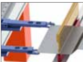
⤵ Gráficos que muestran las diferentes posibilidades de apoyo de la chapa sobre los cabezales del tope trasero.
